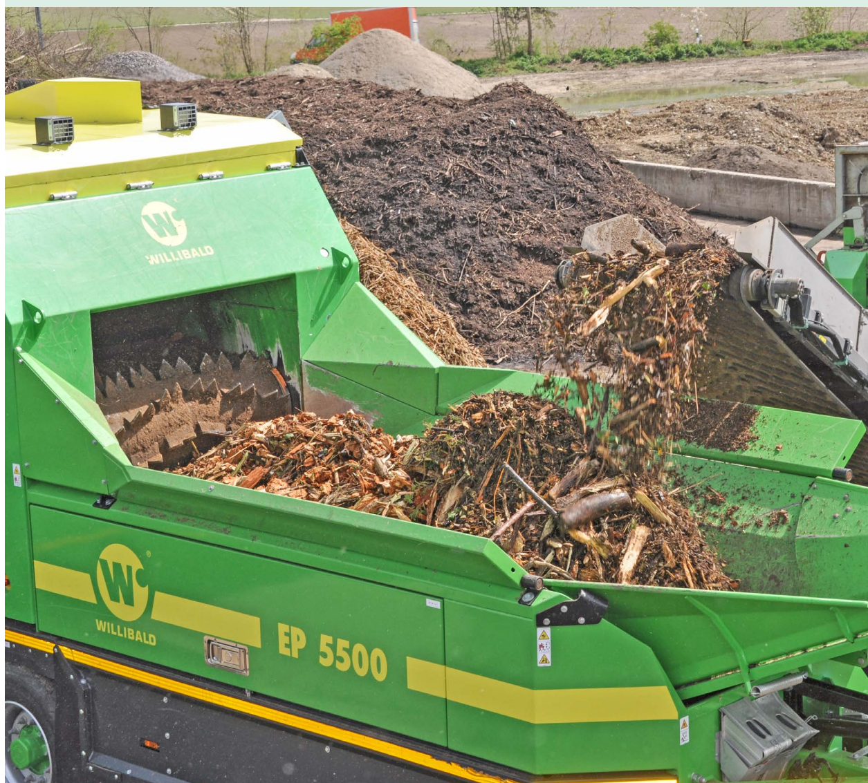
Knusper Knusper Knäuschen: Der Langsamläufer zerkleinert das holzige Schwemmgut auf 25 cm Länge. Ce broyeur à rotation lente réduit les déchets flottants ligneux à 25 cm de longueur
